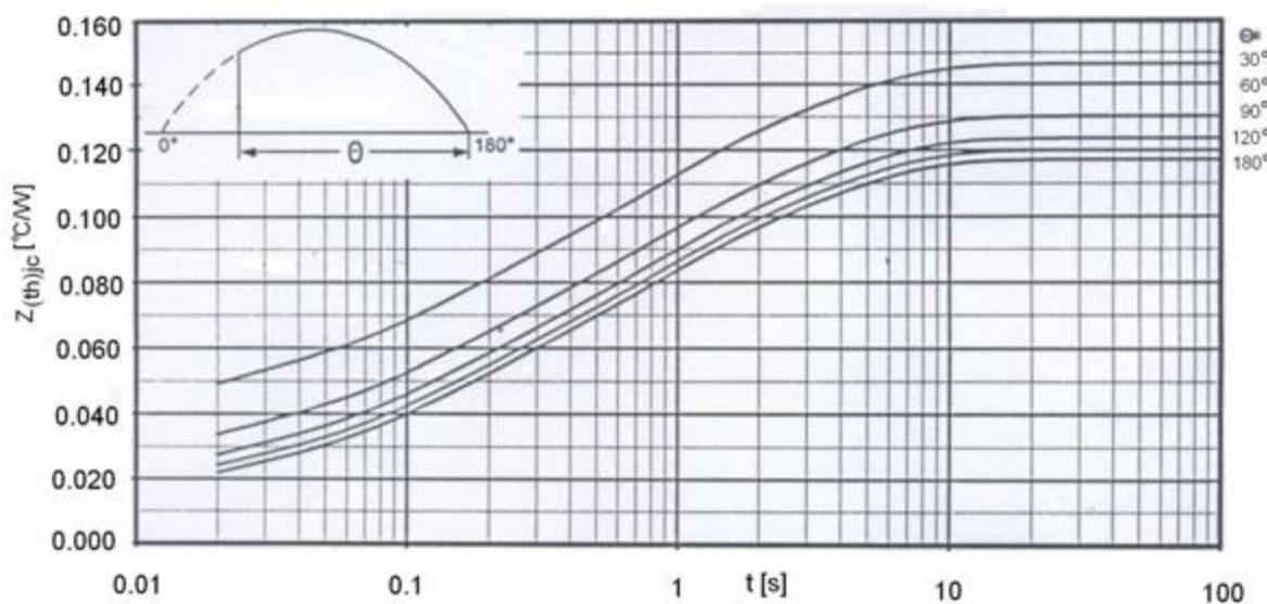
Transient thermal impedance per arm  $Z_{thc} = f(t)$
