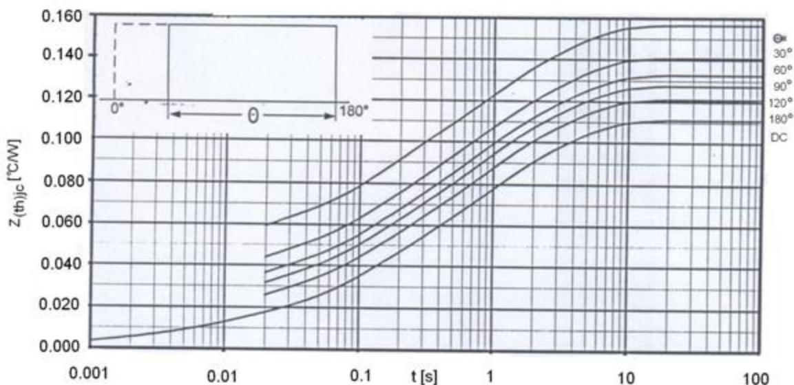
Transient thermal impedance per arm  $Z_{thc} = f(t)$
